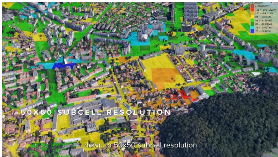
行動網路優化定位平台 (CovMo™) 介面以顏色區分訊號強度，並能以 3D 立體圖像呈現，清楚呈現各區用戶數多寡，協助電信業客戶改善用戶網路訊號品質、優化基地台效能，並建議未來大型基地台、小型基地台 (Small Cell) 部署點等。
